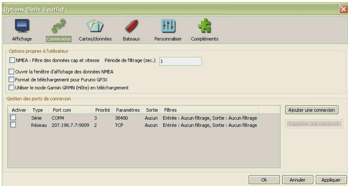
Même mode opératoire que dans les anciennes versions, sauf un nouveau masque de saisie qui permet maintenant d'avoir des entrées, des sorties et des entrées-sorties pour sondeur, speedo, girouette, thermomètre, AIS classe B ou A, etc... Détail sur le lien Equipement matériel ou Voir
