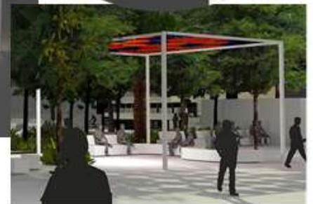
Structure métallique acier Galvanisé à chaud par immersion. (UNE EN ISO 1461) \_ Thermolaquage blanc
