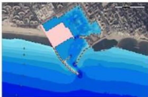
Figure 34. Bathymétrie de modèle d'agitation - Etat projet
